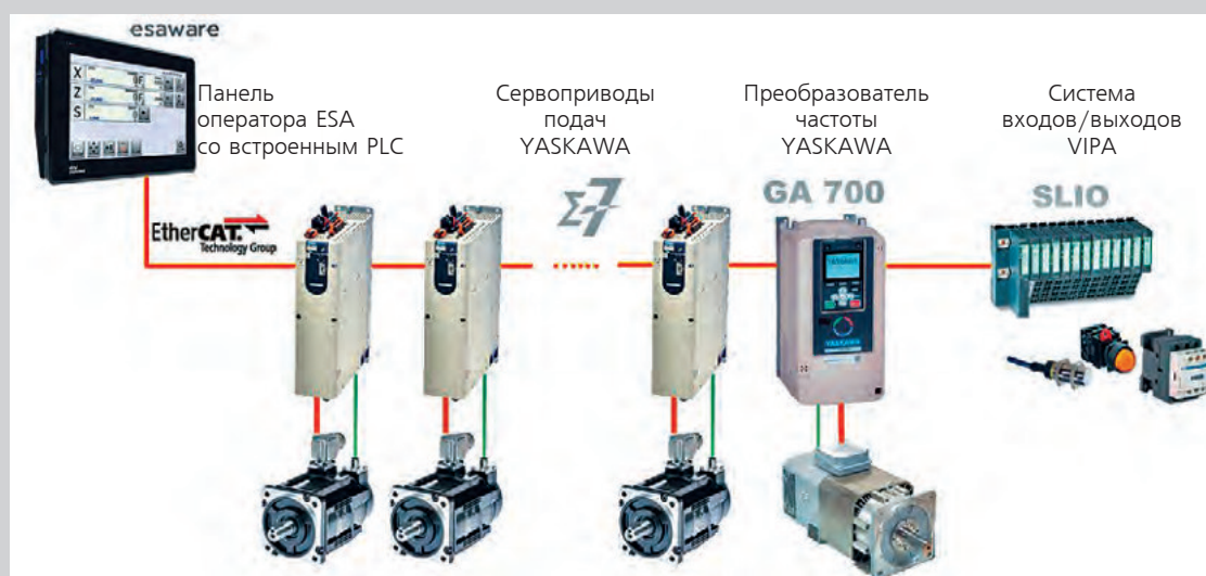
Рис. 1. Структурная схема системы СИПУ «АЛЬФА+ ЗЕК» от ООО «КоСПА»
