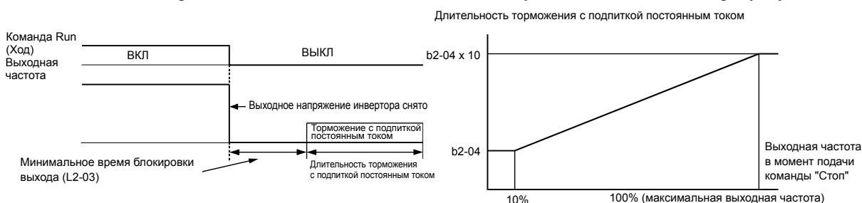
Рис. 6.16 Торможение с подпиткой постоянным током
