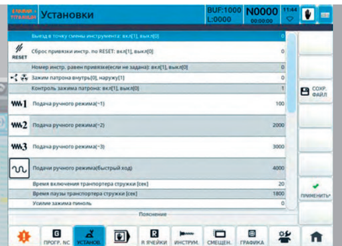
Рис. 4. Экран параметрического программирования ПЛК
