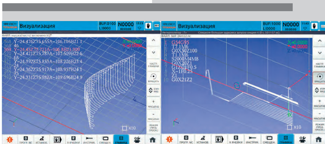
Рис. 6. Графическое отображение траектории инструмента
