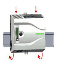
**3.** Наденьте модуль ЦПУ его верхней частью на монтажную рейку и поверните его сверху вниз до упора.
