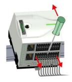
В случае замены устройства съёмные соединители могут быть извлечены из него с помощью отвёртки. Для этой цели каждый соединитель в верхней части имеет специальную выемку. Извлечение осуществляется в следующей последовательности:
