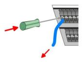
Извлечение проводов из клеммного соединителя осуществляется с помощью отвёртки с прямым шлицем шириной 2,5 мм.
