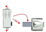
Коммуникационный модуль на тыльной стороне имеет два фиксатора – верхний и нижний. Вытяните тяги обоих фиксаторов наружу на один щелчок, как показано на рисунке.
