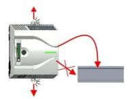
3. Вытяните у нового ЦПУ тяги фиксаторов наружу на один щелчок.
