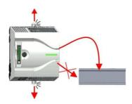
4. Вытяните у нового ЦПУ тяги фиксаторов наружу на один щелчок.
