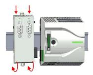
**3.** Наденьте коммуникационный модуль его верхней частью на монтажную рейку и поверните его сверху вниз до упора.
