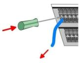
Извлечение проводов из клеммного соединителя осуществляется с помощью отвёртки с прямым шлицем шириной 2,5 мм.
