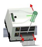
В случае замены устройства съёмные соединители могут быть извлечены из него с помощью отвёртки. Для этой цели каждый соединитель в верхней части имеет специальную выемку. Извлечение осуществляется в следующей последовательности:
