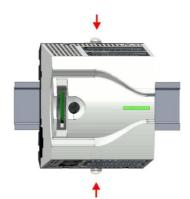
**6.** Закрепите модуль ЦПУ на монтажной рейке, переведя тяги его фиксаторов в исходное (утопленное) положение.
