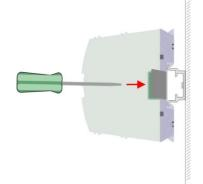
**1.** С помощью отвёртки удалите заглушку разъёма системной шины модуля ЦПУ, расположенную на его правой боковой поверхности.
