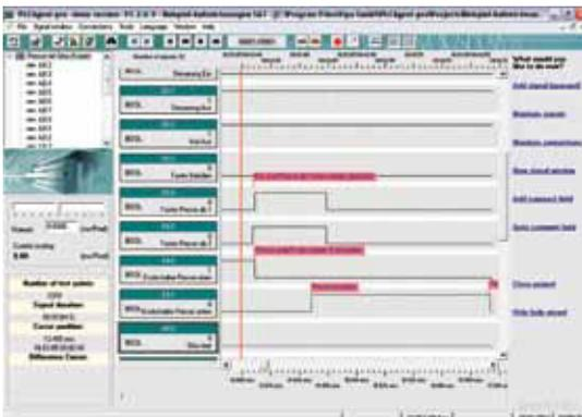
WINPLC-Analyzer – программное обеспечение для записи данных о состоянии ПЛК (входы, выходы, таймеры, счетчики, переменные) и их анализа.
