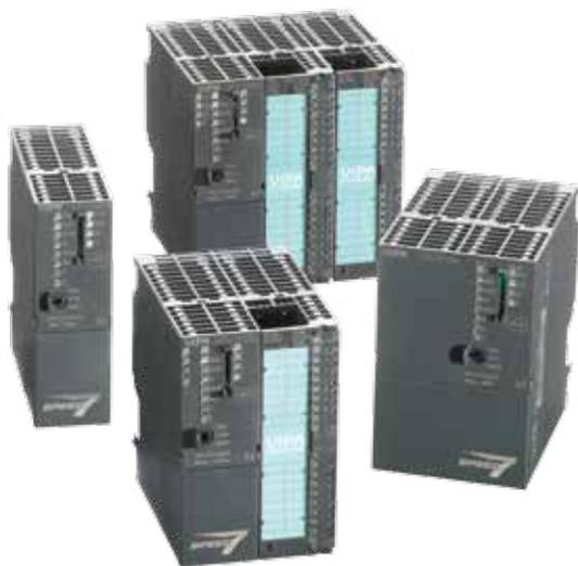
Оборудование системы 300S+ предназначено для построения высокопроизводительных разветвленных систем промышленной автоматизации с высокими требованиями к производительности. Процессорные модули поддерживают непосредственное подключение до 32 модулей в один ряд, а также до 126 станций ввода-вывода в качестве распределенной периферии.
