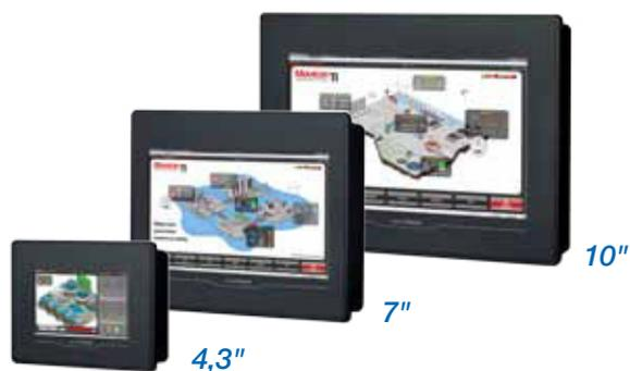
Графические панели оператора серий Smart и Cloud имеют одинаковую аппаратную платформу, но благодаря отличающемуся набору предустановленного в них программного обеспечения обеспечивают решение различного класса задач при реализации человеко-машинного интерфейса.
