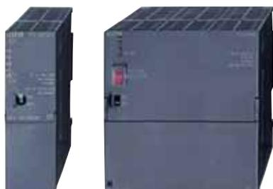
Блоки питания преобразуют входное напряжение сети переменного тока в напряжение 24 В постоянного тока, которое используется для питания модулей системы, а также датчиков и исполнительных устройств. Блоки питания крепятся на ту же профильную монтажную шину, что и другие модули серии System 300S+. При этом они не имеют электрического соединения с системной шиной ПЛК.
