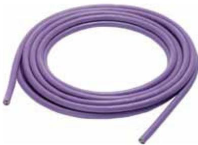
Представляет собой экранированную витую пару изолированных одножильных проводников в оболочке из поливинилхлорида фиолетового цвета. Кабель позволяет осуществлять быстрый монтаж соединительных линий сети PROFIBUS DP благодаря использованию для подключения к соединителям технологии прорезания изоляции (Fast Connect), а также применению для его разделки специального инструмента. Кабель поставляется отрезками по 100, 200, 500 и 1000 м.
