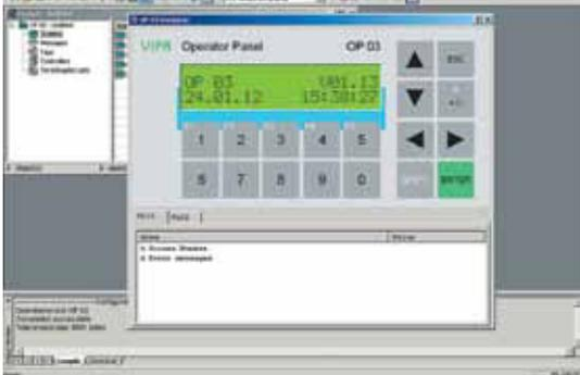
Программное обеспечение OP-Manager предназначено для конфигурирования панелей оператора OP 03 и компактных систем управления CC 03.
