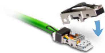
Состоят из двух компонентов. Корпус литой из цинкового сплава. Монтаж осуществляется без использования специализированного инструмента. Совместимы с кабелем категории 6А как с одножильными, так и с многожильными проводниками. Имеют фиксирующую защелку.
