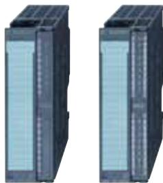
Модули дискретного ввода-вывода служат для подключения к системе датчиков и исполнительных устройств и обеспечивают сопряжение системы с уровнем процесса. Модули дискретного ввода получают двоичные сигналы управления от датчиков и преобразуют их во внутренние сигналы системы. Модули дискретного вывода осуществляют обратное преобразование внутренних данных системы в электрические сигналы управления исполнительными устройствами.
