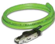
Кабель типа "витая пара" категории 5е для Industrial Ethernet. Имеет 2 пары медных одножильных проводников диаметром 0,64 мм. Экран из алюминиевой фольги и медной оплетки. Наружная изоляция из ПВХ. Внешний диаметр 6,5 мм. Диапазон рабочих температур -40°C...+75°C.
