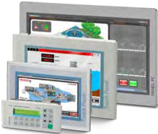
Панели оператора VIPA позволяют с полным объемом решать задачи построения человеко-машинного интерфейса. Они пригодны для управления как локальными установками, так и для работы в составе многоуровневых распределенных систем автоматизации.
