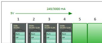
Для систем серии SLIO выполняется расчёт и отображение значения суммарного тока потребления сконфигурированных модулей. При достижении приблизительно 70% от максимального значения выходного тока источника питания системной шины цвет стрелки меняется с зелёного на оранжевый. При достижении приблизительно 90% от максимального значения тока источника питания системной шины цвет стрелки становится красным.
