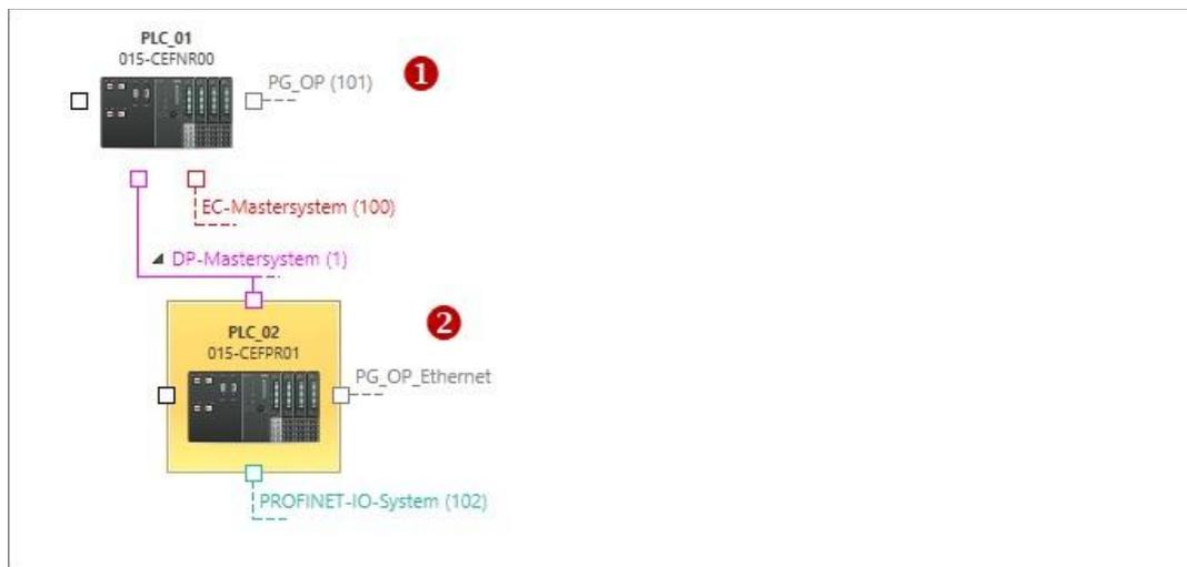
Рис. 62. Контроллеры в окне редактора *"Devices and networking"* (*Устройства и сети*).
