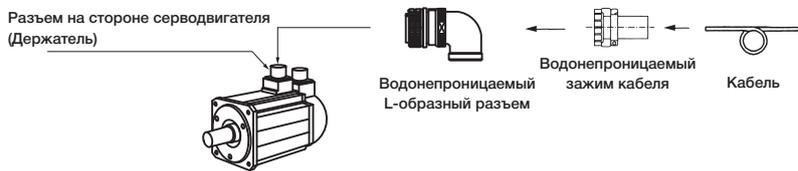
SGMGV Серводвигатель. Прим.: Для того, чтобы получить информацию о заземлении кабельного канала, обратитесь к изготовителю такого канала.
