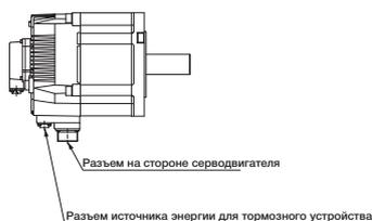
Разъем источника энергии для тормозного устройства 0,85...15 кВт
