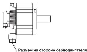
Разъем на стороне серводвигателя 0,85...15 кВт
