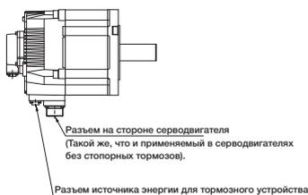
Разъем источника питания тормозной системы (0.85 - 15 кВт)
