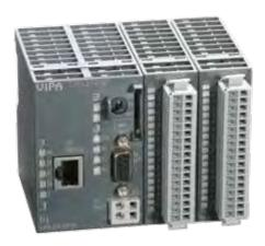
System 200V представляет собой компактный модульный ПЛК, предназначенный для реализации централизованных и распределенных систем управления.
