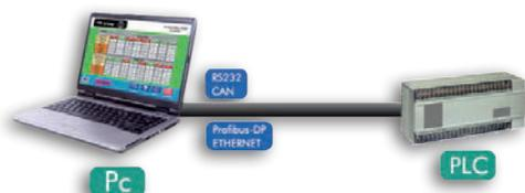
Проект **Polymath** можно **модулировать в режиме offline непосредственно на ПК**, не перемещая его на терминал. Работа симулятора в режиме online, с другой стороны, **позволяет тестировать** разработанный проект, **подключив тестируемые устройства** (например, ПЛК) **непосредственно к ПК**, позволяя тем самым подтвердить полную работоспособность проекта, не используя панель оператора.
