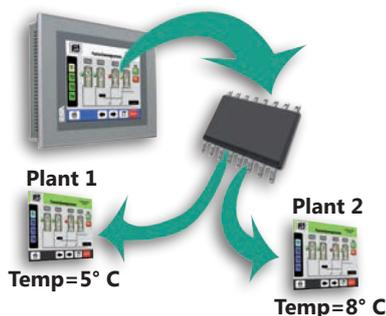
**Косвенная адресация** позволяет значительно **сократить время разработки проекта**, особенно в случае **сложных проектов** со многими **похожими страницами и функциями**. Благодаря этой функции значения переменных **определяются динамически во время выполнения**; таким образом, **заданные страницы и функции могут создаваться непосредственно при выполнении**.
